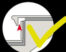
Рекомендуем производить укладку с учётом воздушного зазора 3-4 мм.
